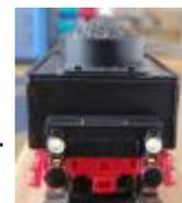
Für die Beleuchtung der Lok wurden vom Dekoder die zwei Leitungen durch die Löcher der Fahrstromverbindung nach außen gezogen und an die Enden gewinkelte Drahtstücke für die Kontakthülsen an der Lok angelötet.
