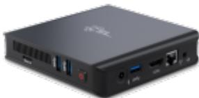
Die Panel-Software, die ursprünglich bei der Firma ITRA entwickelt wurde, stellt keine großen Anforderungen an die Hardware. Mit aktuell angebotenen Mini-PCs ist ausreichend Performance vorhanden. Diese Mini-PCs haben meist keinen aktiven Lüfter und können leicht hinten an den Monitor montiert werden. Sie basieren auf Laptop-Prozessoren und haben alle Komponenten integriert:
