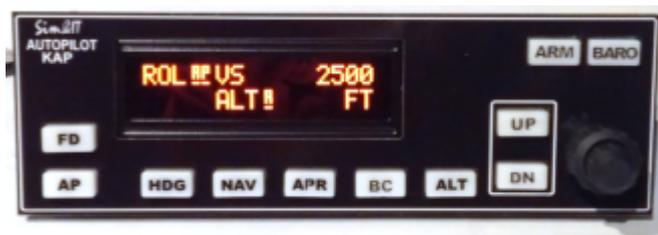
Das Autopilot-Panel ist ähnlich aufgebaut wie die Avionics-Panel mit LC-Display und wurde in Anlehnung an das KAP-140 gestaltet. Das Panel wird über Ethernet mit dem FS-PC verbunden. Der Arduino-Sketch verarbeitet die Taster-/Drehgeber-Ereignisse, die über UDP (Ethernet) zu einer Schnittstellensoftware auf dem PC übertragen werden, der hieraus FS-Kommandos generiert. Die aktualisierten Variablen werden an das
