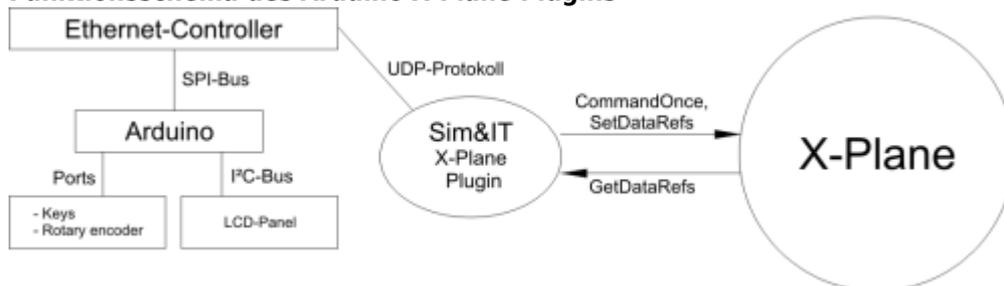
Das X-Plane Plugin kommuniziert direkt mit der Arduino-Hardware über das Netzwerkprotokoll UDP.
