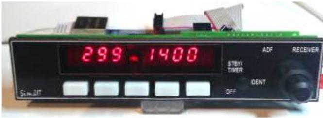
Das ADF-Panel ist ähnlich aufgebaut wie die Avionics-Panel mit LC-Display und wurde in Anlehnung an das KR-87 gestaltet. Das Panel wird über Ethernet mit dem FS-PC verbunden. Der Arduino-Sketch verarbeitet die Taster-/Drehgeber-Ereignisse, die über UDP (Ethernet) zu einer Schnittstellensoftware auf dem PC übertragen werden, der hieraus FS-Kommandos generiert. Die aktualisierten Variablen werden an das Arduino-Panel
