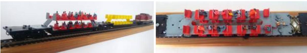
In die Mitte des Oberdecks wurde ein breiter Schlitz eingefräst, damit dort der zweite Lichtbalken hineinpasst und nicht im Unterdeck zu sehr zu sehen ist.
