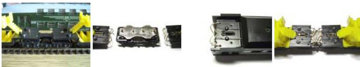
Der Abstand beider Einheiten kann damit deutlich verkürzt werden. In der Kurve auch mit Radius 380mm funktioniert das sehr gut. Auch Schieben ist möglich. Die zweiteilige Einheit wird auch zum [Steuerwagen](#) umgebaut.
