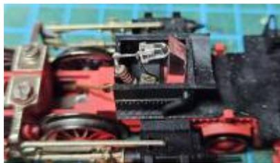
Der erste Umbau gestaltete sich recht einfach. Die Fassung ist mit einer Isolierscheibe und Schraube am Rahmen befestigt und gibt so Kontakt an die Mitte der Glühbirne. Der Draht vom Decoder ist an der Seite der Fassung angelötet.
